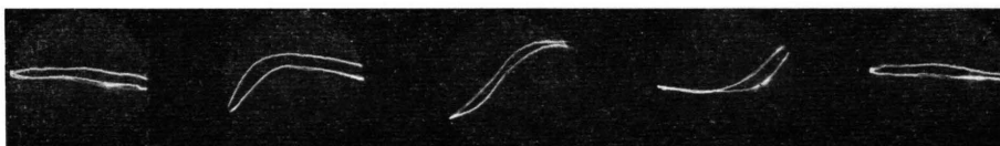
Abb. 2. Oszillogramme des Protonenresonanzdurchganges bei einer 1-m. \text{MnSO}_4 -Lösung.
